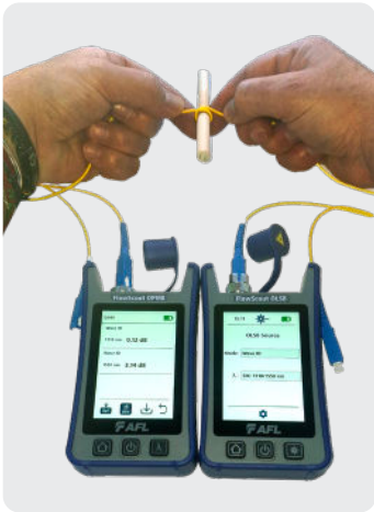
SR15E (8.6µm MFD) B3 Mandrel (Ø10mm) 1310nm – 0.12dB 1550nm – 3.14dB
