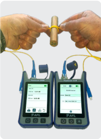
SR15E (8.6µm MFD) A1 Mandrel (Ø20mm) 1310nm – 0.01dB 1550nm – 0.03dB
