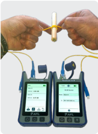
SR15E (8.6µm MFD) A2 Mandrel (Ø15mm) 1310nm – 0.01dB 1550nm – 0.37dB
