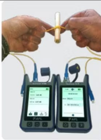
SR15E (8.6μm MFD) A2 Mandrel (Ø15mm) 1310nm – 0.01dB 1550nm – 0.37dB
