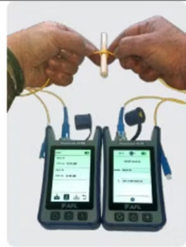
SR15E (8.6μm MFD) B3 Mandrel (Ø10mm) 1310nm – 0.12dB 1550nm – 3.14dB
