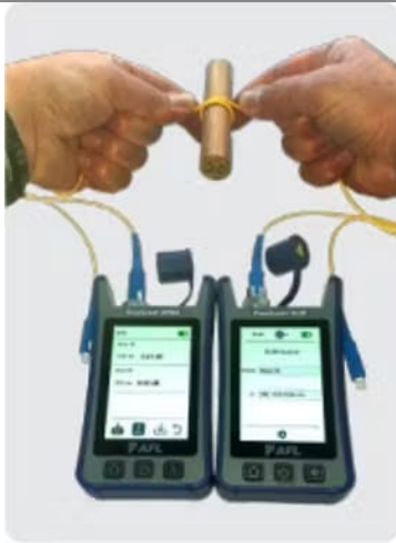
SR15E (8.6μm MFD) A1 Mandrel (Ø20mm) 1310nm – 0.01dB 1550nm – 0.03dB
